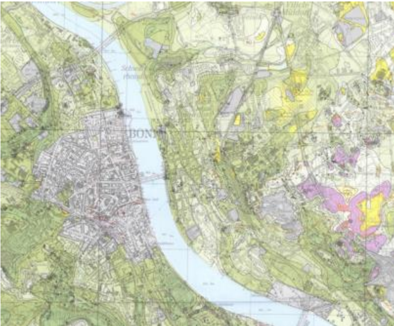
Bild 3: Ausschnitt IGK Bonn. Die unterschiedlichen Farben geben die Dicke der bindigen Schichten über dem Kiessand der NT an
