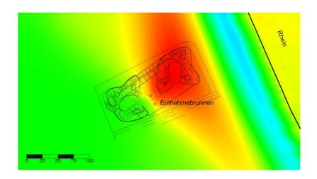
Die Grundwasserentnahme führt – unter anderem in Abhängigkeit von der Entfernung der Brunnen zum Rhein - zu einem vermehrten Einströmen von Rheinwasser in den Grundwasserleiter. Da die Temperatur des geförderten Wassers vom Anteil an infiltriertem Rheinwasser zu Grundwasser abhängt, kann es zu einer sukzessiven Erhöhung der Wassertemperaturen im Umfeld der Entnahmebrunnen kommen.
