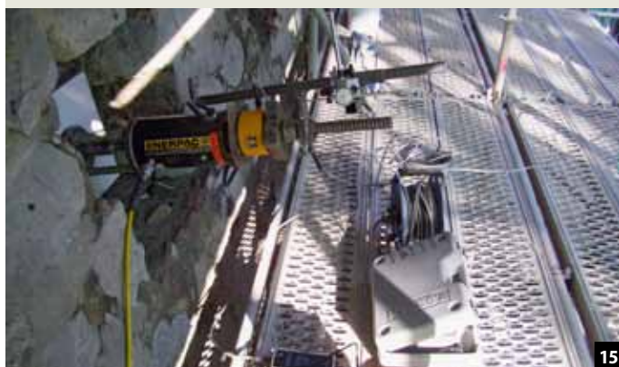
Abb. 15: Die Bemessungszuglasten der Nägel wurden mit Zugprüfungen nachgewiesen.
