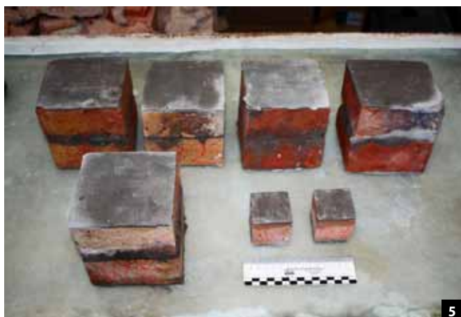
Abb. 5: Die Druckfestigkeit von Vollziegeln lässt sich an halbierten und aufgedoppelten Ziegelsteinen oder auch an kleinformatigen Würfeln bestimmen. Für eine ebene und planparallele Oberfläche werden die Proben abgeglichen.
