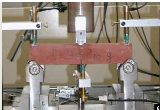
Abb. 6: Für genauere Berechnungsverfahren, zum Beispiel Finite-Elemente-Berechnungen, kann es erforderlich sein, die Mauersteineigenschaften unter Zugbeanspruchung zu ermitteln, so wie hier im Biegezugversuch.
